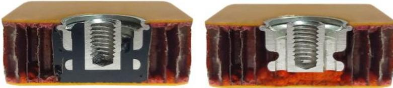
Autre atout du **SECAMnida®** : son poids. L'insert est développé dans un alliage d'aluminium qui allie résistance et aptitude à la déformation pour le sertissage, avec un renfort des filets intérieurs et l'ajout d'un filet rapporté en inox de sorte à obtenir le meilleur ratio résistance mécanique / poids.
