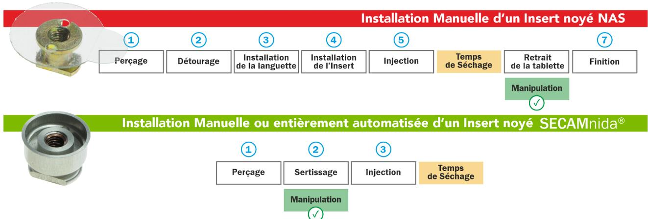
Du point de vue de la réduction des coûts de non-qualité, les gains engendrés par notre technologie sont très significatifs : lorsqu'un défaut géométrique dû à une pose non conforme est détecté après collage des inserts NAS traditionnels, cela oblige à une réparation complexe et coûteuse. L'emploi de l'outil de sertissage spécialement développé pour l'insert **SECAMnida®** garantit un haut niveau de **répétabilité et de positionnement** (affleurement, coaxialité).
